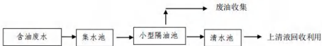
图 6.1-1 施工含油废水处理措施工艺图
